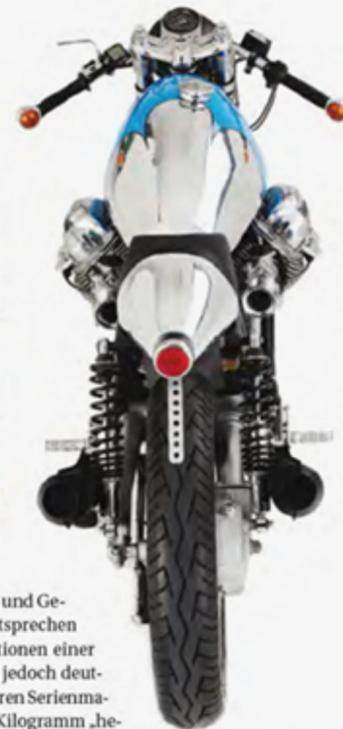
strukteur wie gewohnt von Hand. Auch Motor und Getriebe wurden komplett überarbeitet und entsprechen nun, mit 950 Kubik und 82 PS, den Spezifikationen einer brandneuen Le Mans 1000. Das Gewicht liegt jedoch deutlich niedriger als bei der 240 Kilogramm schweren Serienmaschine: Budde hat die Kaffeemaschine auf 183 Kilogramm „heruntergehungert“ – allein der Rahmen hat 3,5 Kilogramm verloren.
