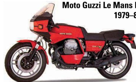
Noch mehr Ecken: Mit überarbeitetem Motor ging die Le Mans III an den Start. Die Zylinderköpfe waren nun eckig, die Ventile arbeiteten deutlich leiser als zuvor und auch die Auspuffgeräusche waren jetzt geringer. Gemeinsam mit einem neuen Luftfiltersystem sorgte all das außerdem für mehr Leistung. Fahrwerk, Getriebe und Rahmen blieben gegenüber der II unverändert, doch dank des neuen Motors gilt die III als das Beste aller Le Mans-Modelle.
