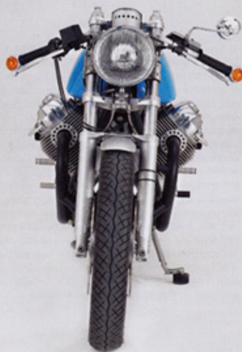
KM1: une base de moteur Le Mans 4 porté à 1040 cm 3 . 90 ch pour 191 kg.
